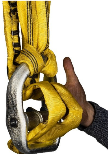
Abb. 5-4: Rundschlinge wird nach unten durchgefädelt
