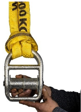
Abb. 5-2: Rundschlinge wird festgezurr
