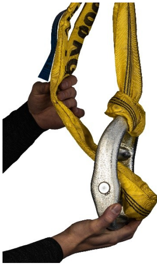
Abb. 5-3: Rundschlinge wird von oben eingefädelt
