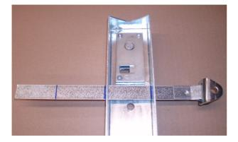
Führen Sie die Bandschellen durch die seitlichen Schlitze der Schiene ein (oben und unten), wie in der Abbildung angezeigt!
